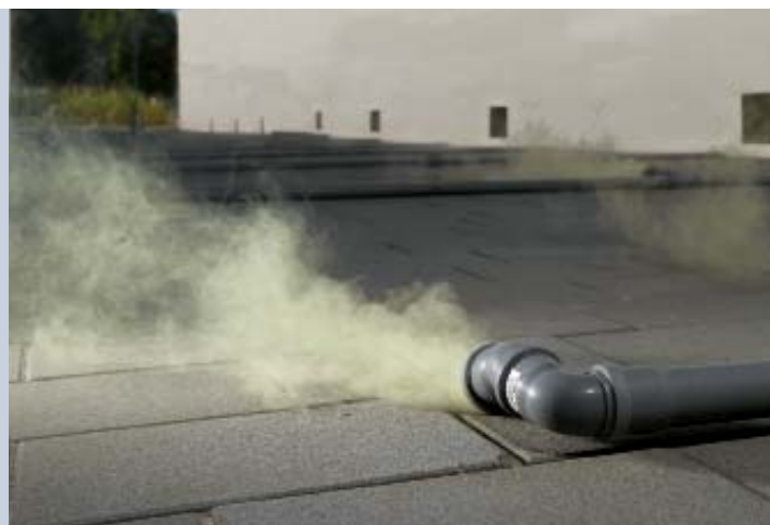
Photokatalytische Pflastersteine tragen zur Reduzierung von Schadstoffen in der Luft bei. Quelle: F.C. Nüdling Betonelemente GmbH & Co. KG
